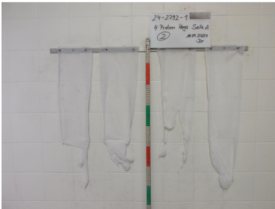
Bild 2: Aussehen der Proben nach dem Brandversuch
