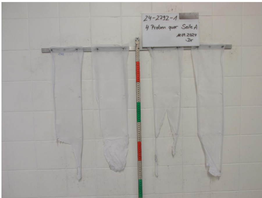
Bild 2: Aussehen der Proben nach dem Brandversuch
