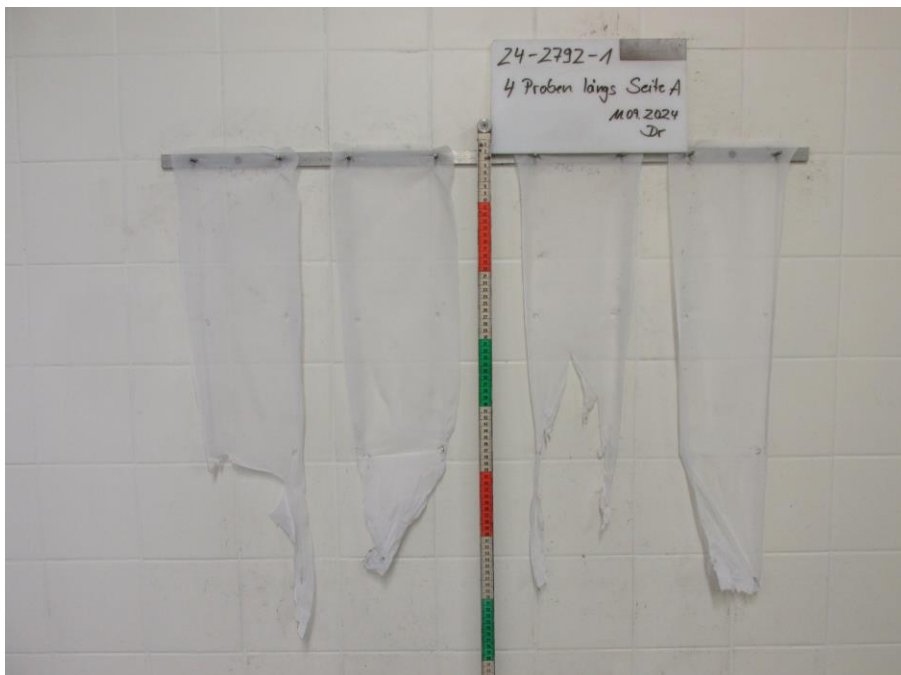
Bild 2: Aussehen der Proben nach dem Brandversuch
