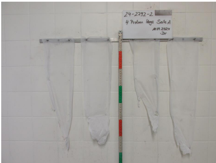
Bild 2: Aussehen der Proben nach dem Brandversuch
