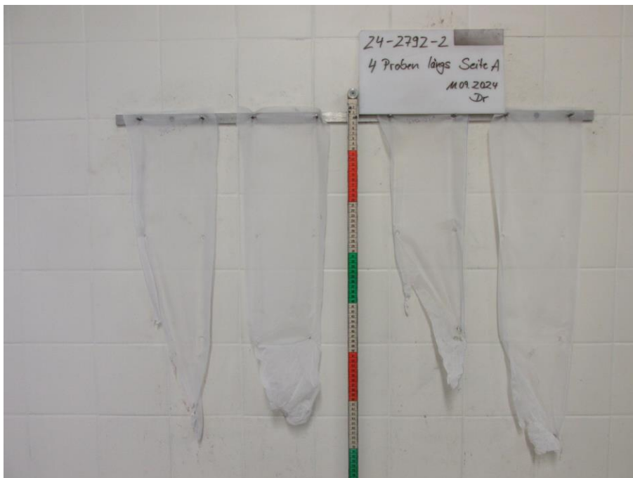
Bild 2: Aussehen der Proben nach dem Brandversuch
